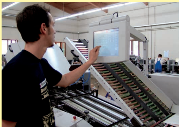
Der gelernte Buchbinder Martin Wurth (32) bei der Einstellung am zentralen Touchscreen am Rundstapelanleger des Flexomailers bei Dinner Druck.
