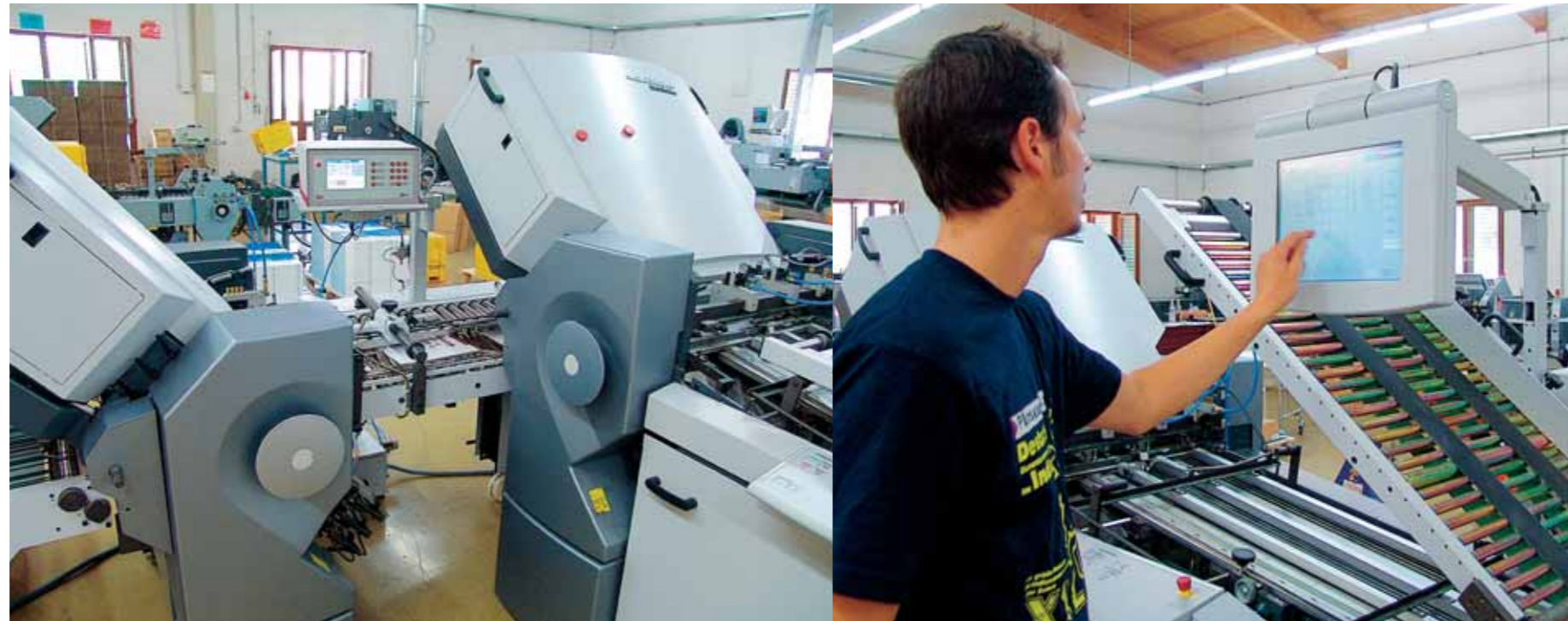
Der gelernte Buchbinder Martin Wurth bei der Einstellung einer höheren Maschinengeschwindigkeit am zentralen Touchscreen am Rundstapelanleger des Flexomailers. Fotos: Heidelberg
