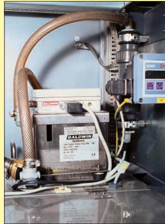
Die Combiliner von Baldwin vereinen mehrere Funktionen in einem kompakten Systemgehäuse (l.). Ipsonic (r.) hilft bei der Zudosierung von Alkohol im Offsetfeuchtmittel.
